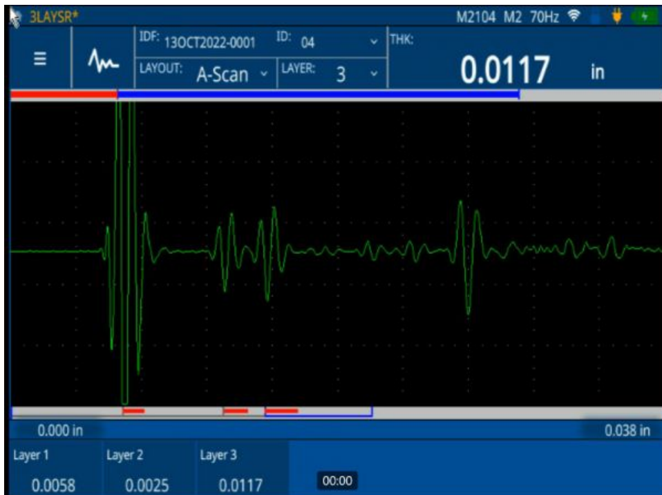
72DL PLUS 초음파 두께 계측기로 수행된 3중 플라스틱 용기의 50MHz 측정
